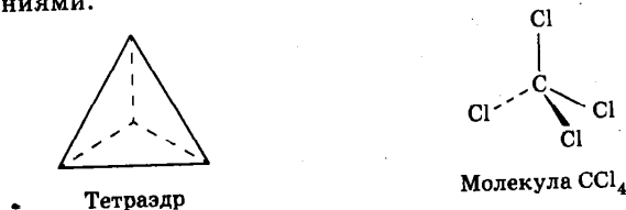
Рис. 3.2. Молекула \text{CCl}_4 имеет тетраэдрическую форму
